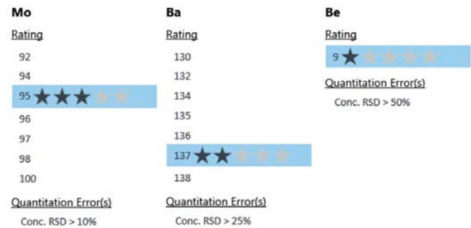
Figura 3. Ejemplos de calificación por estrellas de IntelliQuant de isótopos con distintos niveles de precisión de medición deficiente.
