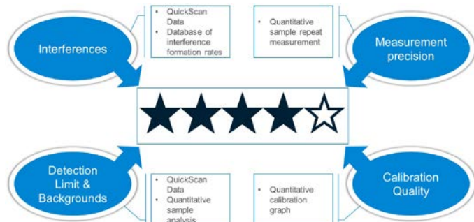
Figura 2. La calificación por estrellas de IntelliQuant utiliza el análisis multivariante para calcular un nivel de confianza para los datos cuantitativos de la muestra.
